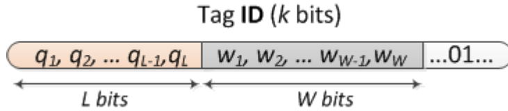
Figura 4.5: Estructura del ID del tag
